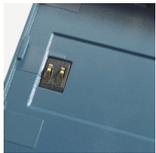
Gegenkontakte für das Akkupack (Firma Bourns, Typ 70ADJ002ML1) zum Einbau in die Unterhalbschale des Gehäuses
